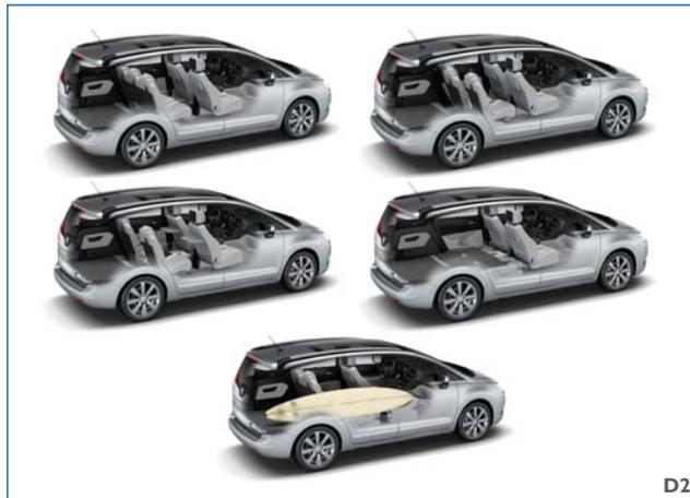
**D2: Modularidad interior Multiflex: configuración 5 plazas o con la tercera fila escamoteada**
