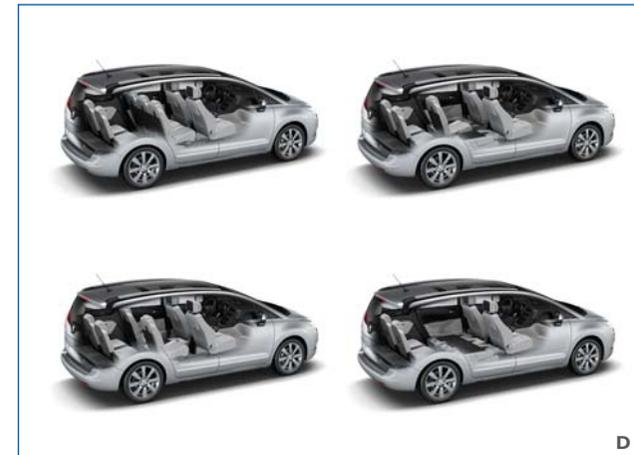
**D1: Modularidad interior Multiflex: configuración 7 plazas**
