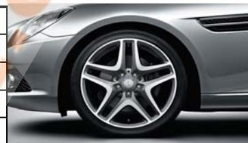
\* Tengan en cuenta en cuanto menor es la sección de un neumático para un mismo tamaño de la llanta, menor es el confort de conducción sobre carreteras en mal estado. En este tipo de ruedas disminuyen el confort de rodadura y de amortiguación y aumenta el peligro de que se produzcan deterioros en las llantas y los neumáticos al sobrepasar obstáculos.
