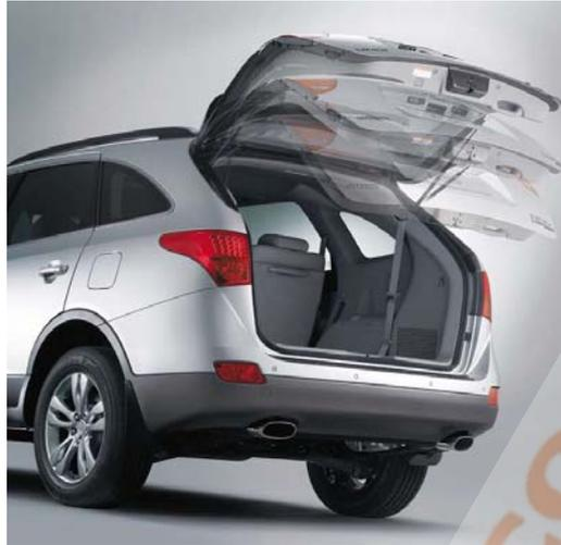
El portón trasero se abre eléctricamente. Para su accionamiento basta con pulsar un botón del mando a distancia de la llave. El paragolpes incorpora 4 sensores de proximidad para evitar sobresaltos en las maniobras de aparcamiento.
