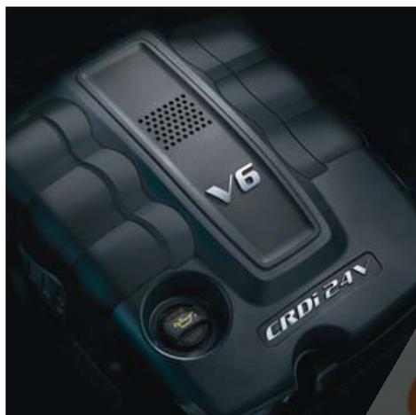
El poderoso motor turbodiesel V6 de 3.0 litros de capacidad con bloque de fundición y culatas de aleación ligera rinde 240 CV a 3.800 rpm
