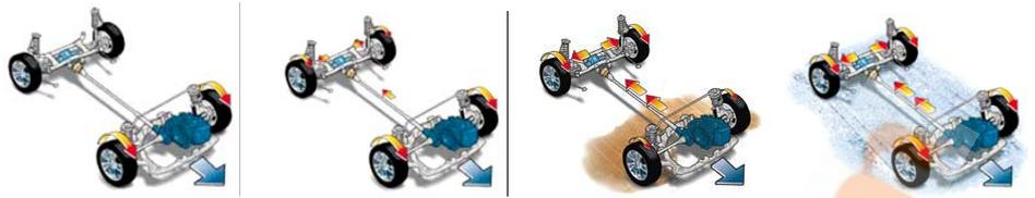
El sistema de tracción total controlado electrónicamente reparte la entrega de potencia entre ejes en función del estado del asfalto
